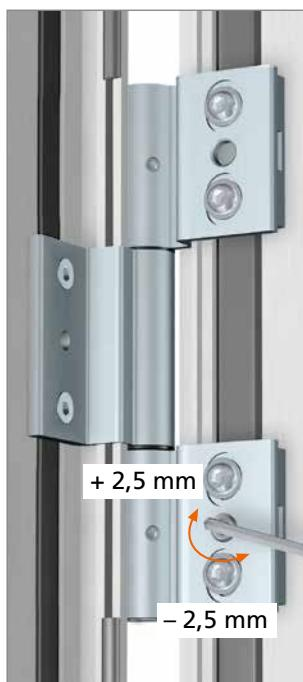
Höhenverstellung durch Exzenter am unteren Band vornehmen (Verstellbereich  $\pm 2,5$  mm).
